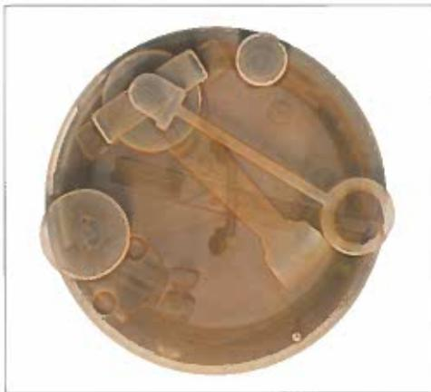
Virtuelles 3D-Modell des Dosensexantanten von oben. Auch die inneren Bauteile sind deutlich zu erkennen. (Grafik: Pia Götz, MAPEX Universität Bremen)
